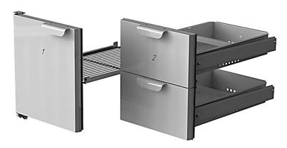
Ширина проемов охлаждаемых столов G, GH, GS, GA, L, GL предполагает возможность загрузки гастронормированных емкостей GN  $1/1^*$ ; 1/2; 1/3. В столах серии В и BD – GN 1/2; GN 1/3. Высота проема составляет 617 мм при высоте стола 810 мм и 395 мм при высоте стола 610 мм. При помощи входящих в стандартный комплект опор возможна регулировка высоты -5...+25 мм.
