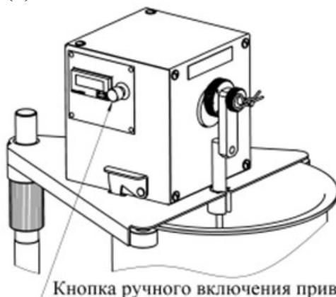
Кнопка ручного включения привода дозатора
