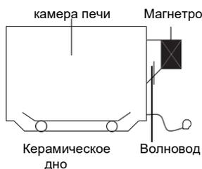
В микроволновой печи электрическая энергия преобразуется в волновую при помощи МАГНЕТРОНА.
